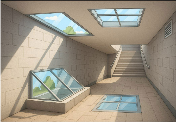
Рисунок 4. Способы использования естественного освещения в подземном пространстве.
